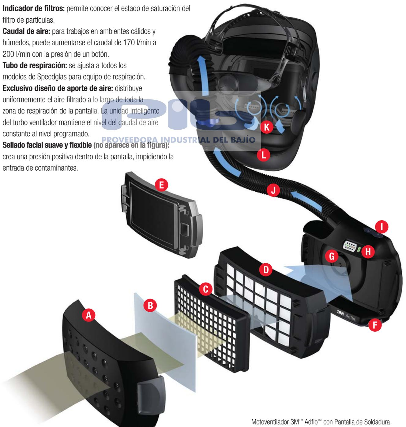
Motoventilador 3M™ Adflo™ con Pantalla de Soldadura 3M™ Speedglas™ 9100 FX Air.
