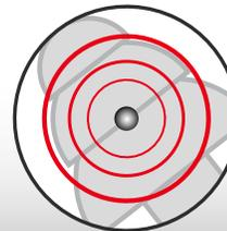
Tapón con inserto metálico interno, diseñado para ser identificado por equipos detectores de metales.
