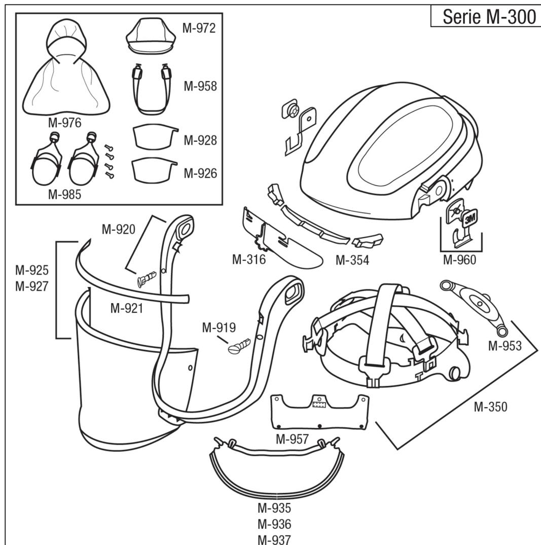
Si descubre algún desgaste y/o daño, saque de servicio el casco y reemplácelo según sea conveniente. 3M sugiere una vida máxima (vida útil más vida de uso) de 3 años a partir de la fecha de manufactura. Consulte las Instrucciones de la Serie M para obtener detalles sobre inspección y reemplazo.
